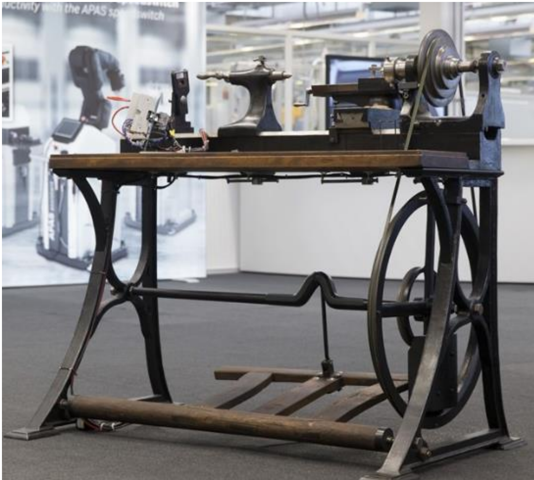
15. ábra retrofit-megoldás lábbal hajtható öntöttvas esztergpadon
